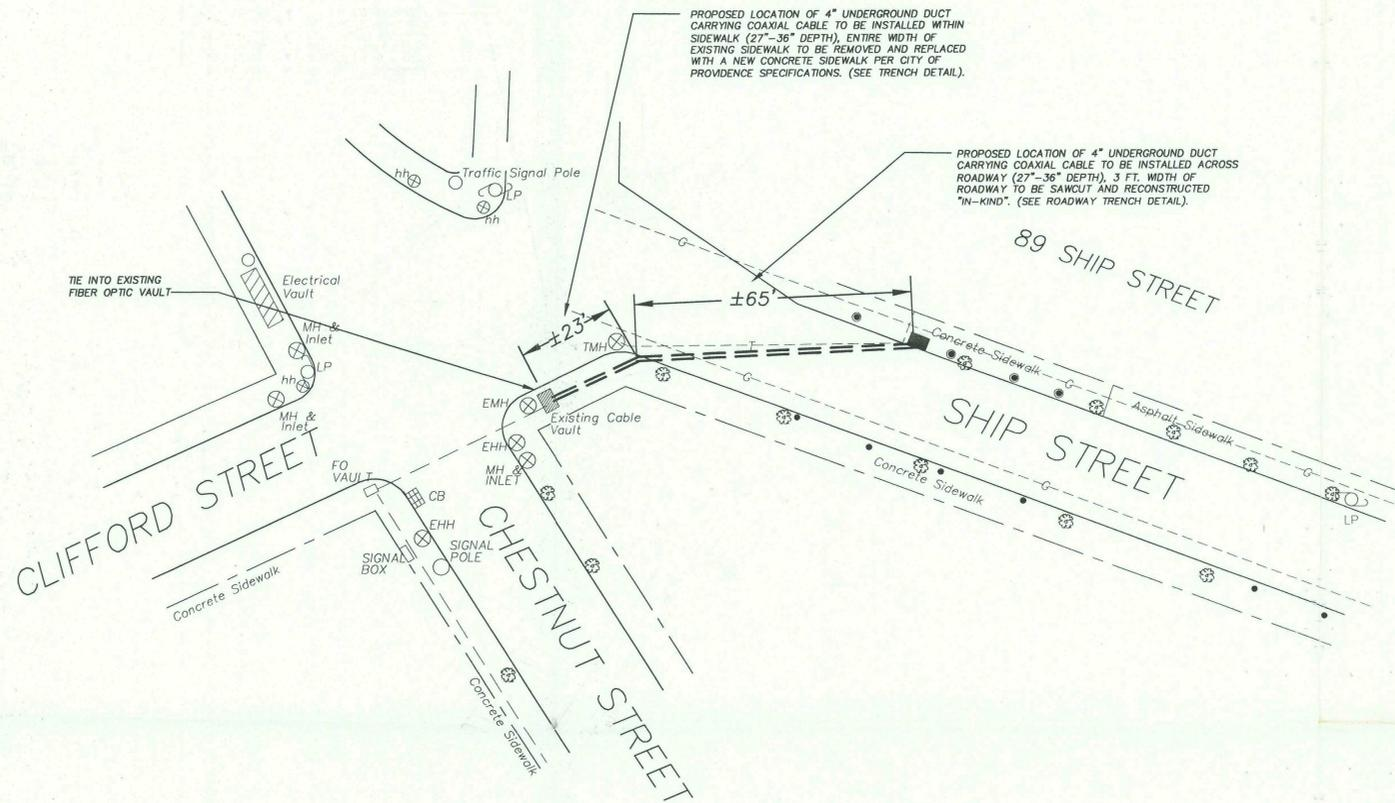
UNDERGROUND FIBER OPTIC CABLE ROUTING PLAN
